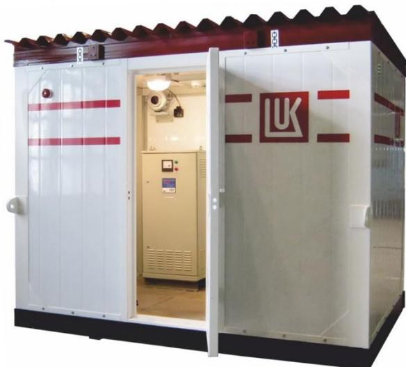
Модули для размещения комплектных конденсаторных установок (в дальнейшем «модули»), предназначены для размещения в них конденсаторных установок для компенсации реактивной мощности на напряжение 0,4; 6,3; 10,5 кВ. Модуль представляет собой металлический утепленный контейнер, что позволяет использовать конденсаторные установки в различных климатических условиях, оперативно вводить в строй оборудование, существенно сократить затраты на монтажные и пуско-наладочные работы.
