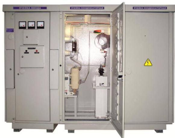
Конденсаторные установки компенсации реактивной мощности используются для повышения коэффициента реактивной мощности электрических систем в промышленных объектах с напряжением от 6 до 10 Кв. Благодаря техническим и эксплуатационным параметрам установок коэффициент мощности при минимальных и максимальных нагрузках на сеть поддерживается в автоматическом режиме и полностью исключается возможность перекомпенсации.
