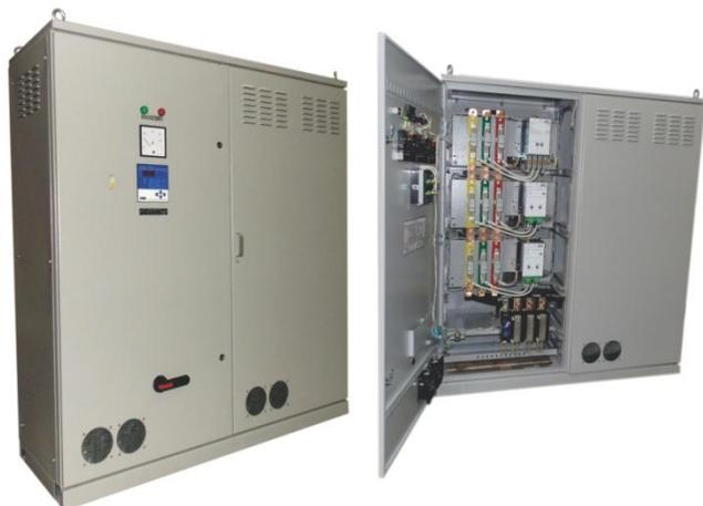
В отличие от установок с контакторами конденсаторные установки с тиристорным управлением УКМТ имеют очень высокую скорость переключения: т.к. не требуется задержка срабатывания на время разряда конденсатора.
